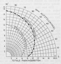
schliesslich Auswirkungen verschiedener Massannahmen für den Normalwagen. Versuche des Verfassers auf dem Basler Mustermesseplatz haben deutlich gezeigt, dass die genannten Grundmasse grösserer Wagen allein befriedigende Verhältnisse ergeben. Sie entsprechen übrigens ziemlich genau den Pariser-Normalien. Sind viele Kleinwagen zu berücksichtigen, werden diesen am besten eigene Parkstreifen geringern Ausmasses zugewiesen, was aber gute Signalisierung und Verkehrsdisziplin voraussetzt.
