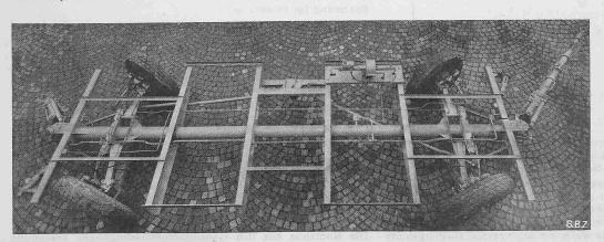
Abb. 3. Draufsicht auf das Gestell des Autoanhängers mit Vierradlenkung Bauart E. Moser, Bern
