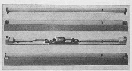
Abb. 6. Stirnansicht, Abb. 7. Gesamtbild einer Armatur. A Leuchtstoffröhre; B Verschalung; C Grundbrett mit Fassungen, Zündgerät, Kupplungsstück, Loch und Schlitz zur Befestigung an Deckenbolzen; D alle drei Teile zusammengestellt
