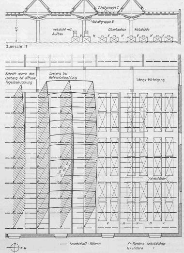
Abb. 2. Teilgrundriss und Schnitt 1:250 des Websaals mit Eintragung der Webstühle (rechts) und der gemessenen Beleuchtungsstärke (links) bei Röhren- bezw. Tagesbeleuchtung
