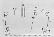
Abb. 1. Schematischer Querschnitt eines Webstuhls ohne Oberbau
