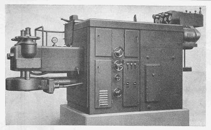
Abb. 8. Vollautomatische Bühler-Teigwarenpresse für 450 kg Stundenleistung
