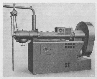
Abb. 7. Vollautomatische Bühler-Teigwarenpresse für 150 kg/h
