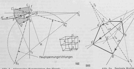
Abb. 5. Allgemeine Konstruktion der Hauptspannungsrichtungen für ebene Verformungen
