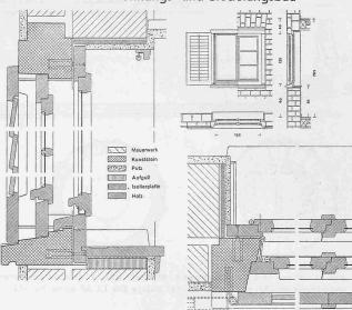
Abb. 5. Wohn- und Schlafzimmerfenster mit Kunststein, 1:100 u. 1:10 Permanent- und Winterfenster. Für den Maurer: Lichtmass  $120\times135$ . Für den Schreiner: Rahmen seitlich und oben mit Haarkalk, Wetterschenkel mit Kitt abdichten. Steinschraubenbefestigung. Für den Gipser: Isolierplatten auf innere Leibungen, usw.
