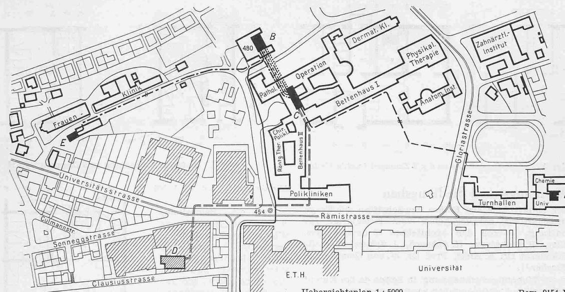
A Verdampferanlage der Wärmepumpe; — Wärmeträger; B Kompressor-anlage; C Wärmevertei-lung; D FHK der E.T.H. E Spitzenswerk der Frauen-klinik; F desgl. Universität
