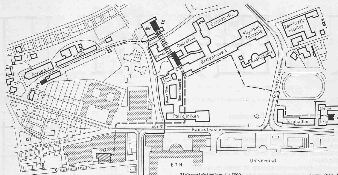
A Verdampferanlage der Wärmepumpe; — Wärmeträger; B Kompressor-anlage; C Wärmeverteilstation; D FHK der E.T.H. E Spitzenswerk der Frauenklinik; F desgl. Universität
