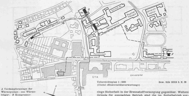
Wärmepumpe; — Wärmeträger; B Kompressoranlage: C Wärmeverteilstation; D FHK der E.T.H. E Spitzenwerk der Frauenklinik; F desgl. Universität
