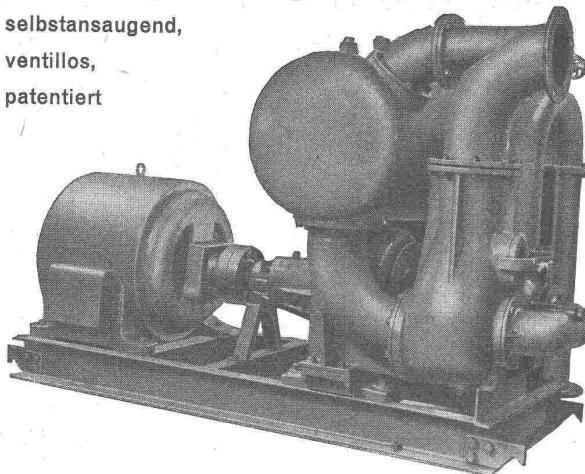
**Saughöhen bis 9 m, Leistungen 1—500 Liter/Sek. Kein Bodenventil · Keine Klappe im Saugstutzen · Keine Hilfs-Vakuum-Pumpe · Jederzeitiges automatisches Ansaugen auch nach Lufteintritt im Saugrohr. Keine reibenden, sich abnutzenden Flächen, daher unempfindlich gegen Sand, Schlamm und Kies.**
