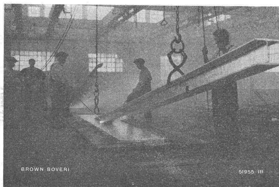
Elektro-Wannenofen für Feuerverzinkung von Röhren und Profilen. Das flüssige Zinkbad hat eine Länge von 8 m und 0,72 m Tiefe; Temperatur 460° C. Anschlusswert 180 kW.
