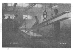
Elektro-Wannenofen für Feuerverzinkung von Röhren und Profileisen. Das flüssige Zinkbad hat eine Länge von 8 m und 0,72 m Tiefe: Temperatur  $460^{\circ}$  C. Anschlusswert 180 kW,
