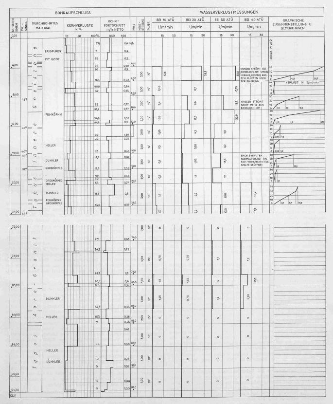
Abb. 7. Bohrprofil einer Kernbohrung in Gneis und Granit, 94,20 m tief, Bohr  $\varnothing$  44 mm, Kern  $\varnothing$  32 mm, Neigung 45  $^{0}$
