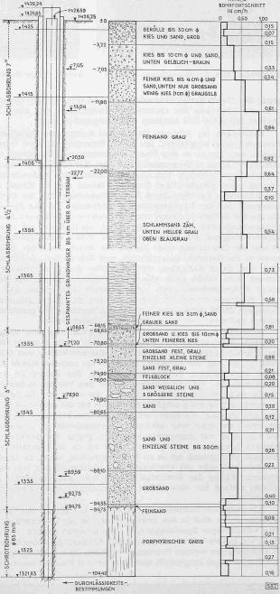
Abb. 1. Bohrung in Lockergestein 94,75 m tief,  $\varnothing$  7 ", 41/2" und 3"
