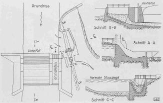
Abb. 3. Einzelheiten des Einlaufbauwerkes, rd. 1:500
