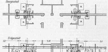
Abb. 2. Wasser- und Abwasser-Installation. 1:125. — Clichiert nach «Z. VDI»
