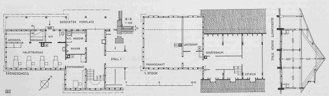
Abb. 2. Grundrisse vom Kopfbau-Erdgeschoss und Obergeschoss, rechts Schnitt der Stallungen. — Masstab 1:250
