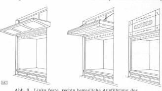
Abb. 3. Links feste, rechts bewegliche Ausführung des Reflexspiegel-Vordaches für Zenitlicht-Einrichtuug
