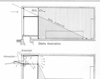
Abb. 2. Schema der Licht- und Schattenwirkung bei üblicher Schaufensteranordnung und bei Zenitlicht (nach 47 Pat. 194867)
