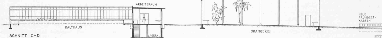
Abb. 4. Neue Stadtgärtnerei der Stadt Zürich. Schnitt C-D (vergleiche Grundriss Abb. 2, Seite 55)
