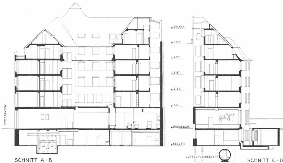
Abb. 9 und 10. Schnitte 1:400 durch das Hotel (vergl. Abb. 18, Seite 279)
