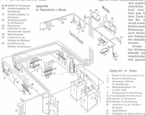
Abb. 24. Schema der Sulzer-Wärmeversorgungsanlage im Hotel Seidenhof, Zürich
