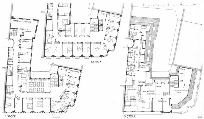
Abb. 4 bis 6. Grundrisse der Obergeschosse des umgebauten Hotel Seidenhof (Erdgeschoss siehe Seite 279). — Masstab 1:400
