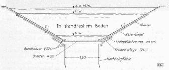
Abb. 1. Normalprofile des Limpach-Hauptkanals. - Masstab 1:150
