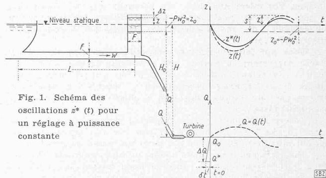
Fig. 1. Schéma des oscillations  $z^*(t)$  pour un réglage à puissance constante
