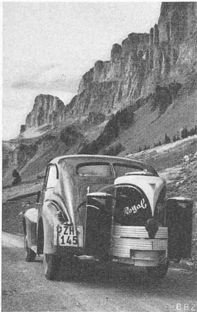
Abb. 2. Royal-Spezial-Generator am Heck eines Personenwagens angebaut, auf der Klausenstrasse Bew. 6057 lt. BRB 3. X. 39
