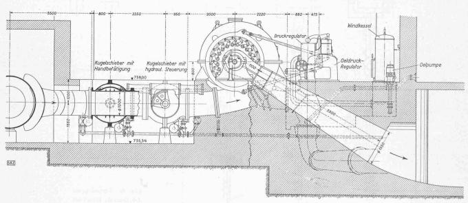
Abb. 27. Zentrale Mörel. Schnitt mit Turbinen-Ein- und Auslauf und Schnitt des ersten Kugelschiebers. — Masstab 1:100
