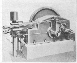
Abb. 2b. Desgl. in heutiger Ausführung: Gewicht rd.  $3\frac{1}{2}$  t,  $n=500~\mathrm{U/min}$
