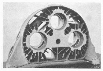
Abb. 3. Siluminguss-Gehäuse eines dreizylindrigen luftgekühlten Rotations-Kompressors
