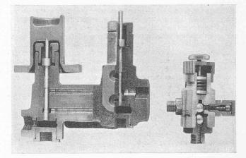
Abb. 4. Pneumatische Differentialdruck-Steuervorrichtung. Links frühere Ausführung mit zwei gewichtsbelasteten Kolben, rechts heutige Ausführung mit Doppelkugel. Gewichtsverminderung auf  $\mathbb{I}_4$
