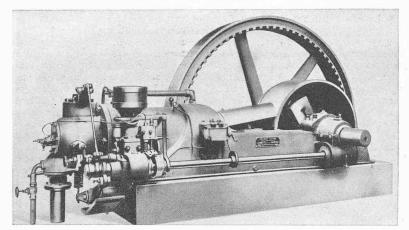
Abb. 2a. Horizontaler Viertakt-Dieselmotor von 60 PS, Konstruktion bis anfangs des vergangenen Jahrzehnts: Gewicht rd. 9 t,  $n=220~\mathrm{U/min}$
