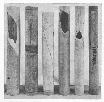
Abb. 20. Bruchbilder von durch Wasserschlag geprüften Eternitrohren
