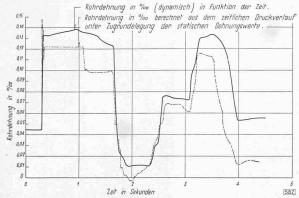
Abb. 17. Rohrdehnungen infolge Druckstoss durch raschen Abschluss des Hydranten A. Messtelle  $Q_{\rm o}=7.539~{\rm l/s}$
