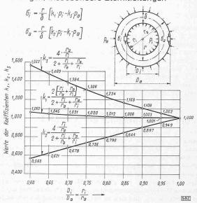
Abb. 18. Max. und min. Randspannungen nach Lamé infolge gleichmässigen Innen- oder Aussendruckes
