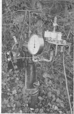
Abb. 12. Messtelle III mit Druckindikator u. Manometer
