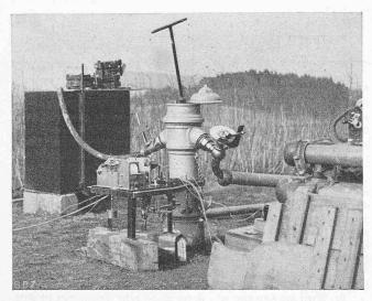
Abb. 13. Erzeugung und Registrierung der Abschlussvariationen. Schnellschluss-Schieber, Flushometer, Hubschreiber und Messbehälter
