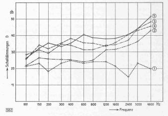
Abb. 2. Schalldämmkurven verschiedener Trennwände 1 Gewöhnliche, undichte Türe; 2 Einfachwand aus Holz, 18 kg/m²; 3 Desgl. 45 kg/m²; 4 Zweischalige Wand, 20 kg/m²;
