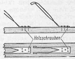
Abb. 1. Holzbewehrte Versuchs-Betonbalken von Ing. E. Sperle, Ulm. Erste Ausführung
