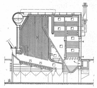
BUSS-La Mont-Dampferzeuger für 32/40 1/h, 50 at, 460° C, ausgerüstet mit BUSS-Ueberschubrost.
