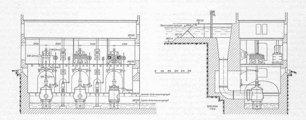
Abb. 2. Anordnung der alten Zentrale mit drei Maschinengruppen von 180 U/min, erbaut 1891/92. — Masstab 1:250 (Cliché MFO)
