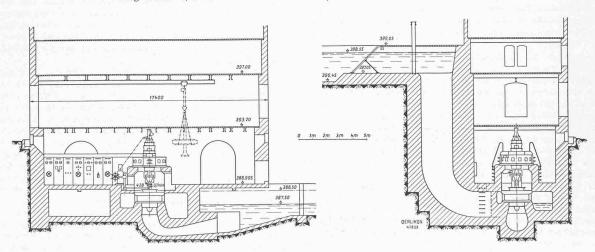
Abb. 4. Anordnung der auf eine Maschinengruppe mit 428 U/min umgebauten Zentrale Hochfelden. — 1:250 (Cliché MFO)
