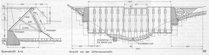
Abb. 2. Entwurf für eine Stauwand aus Holz am Totensee auf der Grimsel. — Masstab 1:200
