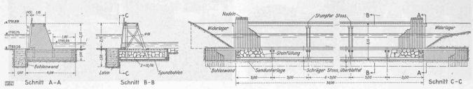
Abb. 3. Erster Entwurf für ein provisorisches hölzernes Nadelwehr am Ausfluss des Silsersees, — Masstab 1:200
