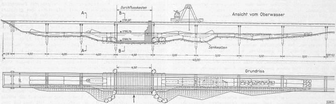
Abb. 4. Provisorischer Stauabschluss aus Senkwalzen und Holz am Silsersee. — Masstab 1: 200
