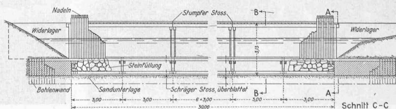
Abb. 3. Erster Entwurf für ein provisorisches hölzernes Nadelwehr am Ausfluss des Silsersees. — Maßstab 1:200.
