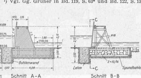
Abb. 3. Erster Entwurf für ein provisorisches hölzernes Nadelwehr am Ausfluss des Silsersees. — Maßstab 1:200
