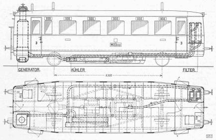
Abb. 2. Holzkohlengas-Triebwagen der Böhmisch-Mährischen Bahnen. — 1:100
