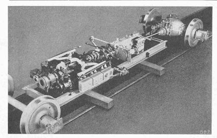
Abb. 3. Hilfsrahmen mit Zwölfzylinder-Boxer-Motor und Viergangwechselgetriebe
