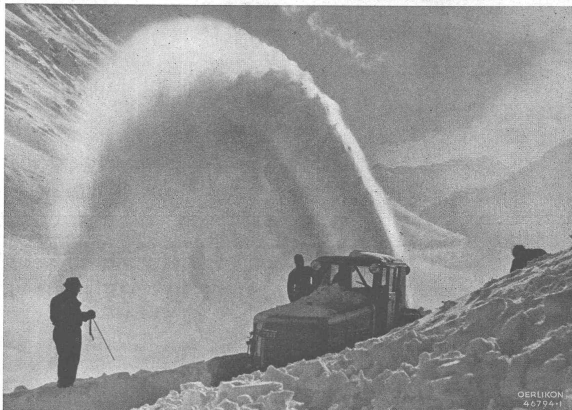
Diesel-elektrische Schneefräse System PETER mit elektrischer Ausrüstung OERLIKON
