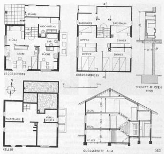
Abb. 3. Grundrisse und Schnitt 1:250 vom grösseren Typ
