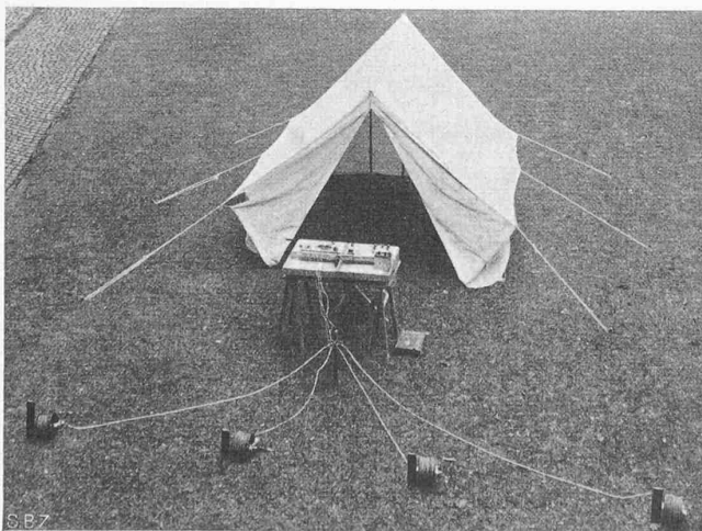
Abb. 4. Geoelektrische Gleichstromapparatur im Felde
