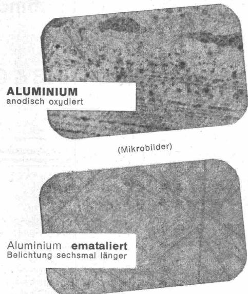
Dieses neueste und modernste Verfahren der anodischen Oxydation erzielt eine bedeutende Erhöhung der chemischen und mechanischen Widerstandskraft des Aluminiums.
