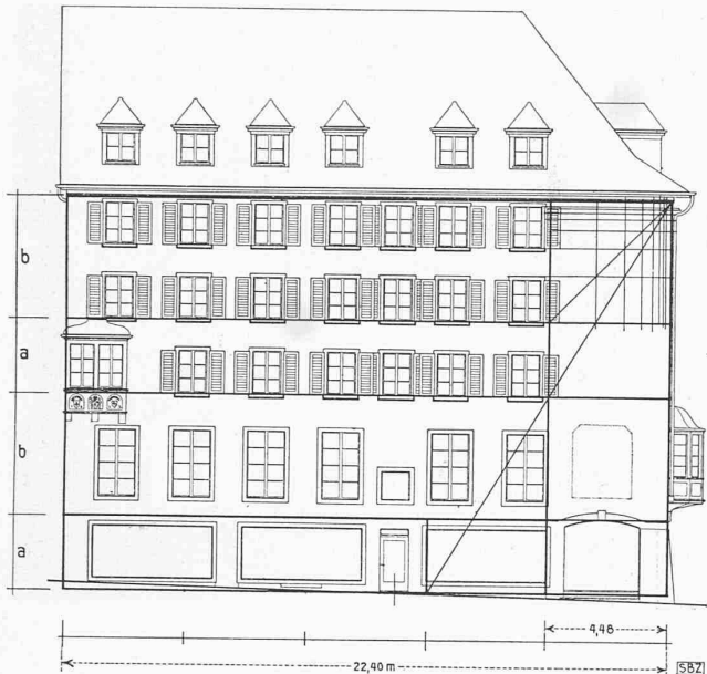
Abb. 3. Fassaden-Schema und «Goldener Schnitt». — 1:300
