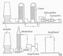
Schaltungen von Winderzeugungs- und Winderhitzungs-Anlagen: Abb. 1 (oben). Kolbengebläse mit Gasmaschinenantrieb und Cowperanlage; Abb. 2 (unten). Turbogebläse mit Dampf-
