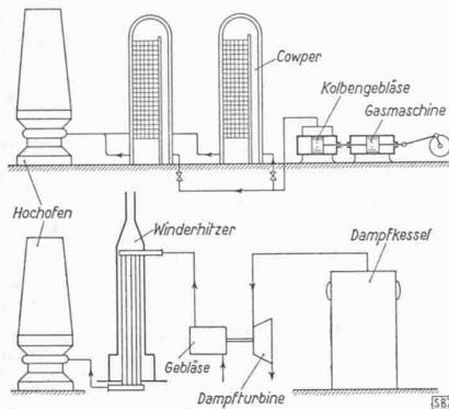
Schaltungen von Winderzeugungs- und Winderhitzungs-Anlagen:
