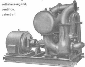
Saughöhen bis 9 m, Leistungen 1—500 Liter/Sek. Kein Bodenventil • Keine Klappe im Saugstutzen • Keine Hilfs-Vakuum-Pumpe • Jederzeitiges automatisches Ansaugen auch nach Lufteintritt im Saugrohr. Keine reibenden, sich abnützenden Flächen, daher unempfindlich gegen Sand, Schlamm und Kies.
