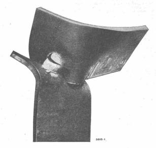
Zerreissversuch an einer Punktschweissung Die geschweisste Verbindungsstelle kann nicht mehr gelöst werden, weshalb eine Art "Niete" entstanden ist. Die elektrische Schweissung ersetzt bei Verbindungen immer mehr das Nieten
