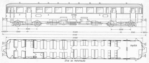
Abb. 2. Typenbild des 300 PS-Diesel-mechanischen Triebwagens. Masstab 1:150
