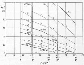
Abb. 9. Zuglasten-Diagramm (Beharrungszustand). Legende: Qn Anhängelast am Zughaken, in t, bei vollbesetztem Triebwagen mit 46 t Bruttogewicht, V Fahrgeschwindigkeit in km/h, I bis V Getriebeabstufung.  $2^{\,0}/_{00}$ .  $4^{\,0}/_{00}$ ,  $10^{\,0}/_{00}$ ,  $20^{\,0}/_{00}$ . . . Steigung in  $^{\,0}/_{00}$
