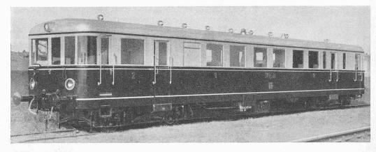
Abb. 1. 300 PS-Diesel-mechanischer Triebwagen der Mittelthurgau-Bahn
