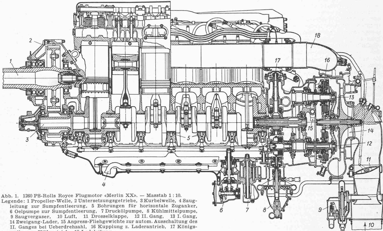
Abb. 1. 1260 PS-Rolls Royce Flugmotor «Merlin XX». — Maßstab 1:10.
