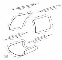
Abb. 16. Gleichgewicht an Schalenelementen u. Längsversteifungen im Ausschnittgebiet
