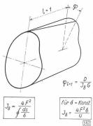
Abb. 6. Massgebende Trägheitsmomente für die Verdrehsteifigkeit von dünnwandigen Hohlzylindern
