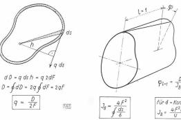
Abb. 5. Ermittlung des Schubflusses für den auf Verdrehung beanspruchten dünnwandigen Hohlzylinder nach Bredt
