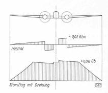
Abb. 3. Verteilung der Verdrehmomente am Flügel im normal. Flug und beim Sturzflug mit unbeschleunigter Drehung um die Längsaxe
