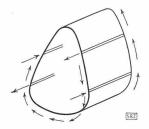
Abb. 17. Schubflüsse und Längskräfte, die im Uebergangsgebiet vor und nach dem Ausschnitt umzuformen sind
