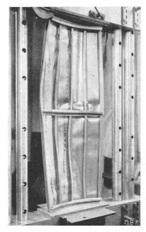
Abb. 29. Ein Ausschnitt aus einem Flugzeugrumpf wird als sog. «Teilschale» dem Druckversuch unterworfen. Die Längsversteifungen haben durch Drillknicken versagt
