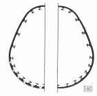
Abb. 26. «Tragender Querschnitt» eines auf Biegung beanspruchten Flugzeugrumpfes, rechts vor dem Ausbeulen, links nach dem Ausbeulen der Blechfelder in der Druckzone
