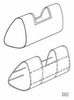
Abb. 12. Ueberbrücken von Ausschnitten in stark gewölbten Teilen von Zylinderschalen durch Rahmen oder durch
