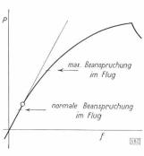
Abb. 23. Last-Verformungskurve einer versteiften Leichtmetallschale
