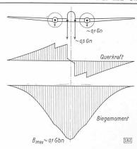
Abb. 2. Verteilung der Querkräfte und Biegemomente im normalen Flug beim Abfangen für ein zweimotoriges Flugzeug (ungefähr 20% des Gewichtes bezw. der Massenkräfte werden am Flügel direkt auf die Luftkräfte abgestützt)
