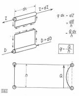
Abb. 14. Der Schubfluss bei Querkraftbiegung im dünnwandigen geraden oder krummen Steg eines Biegeträgers mit starken Gurten und seine Resultierende
