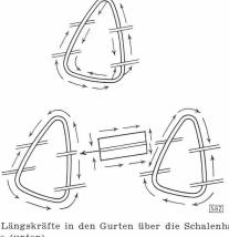
Abb. 20 (rechts). Durchleiten von Flügeldrehmomenten durch einen Rumpf. Der Schubfluss der Drehmomente wird durch Querwände in Kräftepaare formt und in die (nicht gezeichneten) Rumpfseitenwände als Kräftepaare ein-
