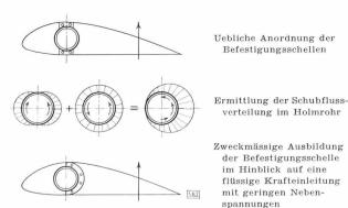
Abb. 21. Befestigung einer Rippe auf dem Holmrohr eines Ruders
