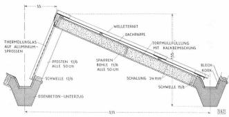
Abb. 22. Schnitt 1:40 durch das Sheddach
