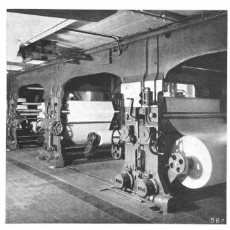
Abb. 16. Unterwerk der Rotationsdruckmaschine
