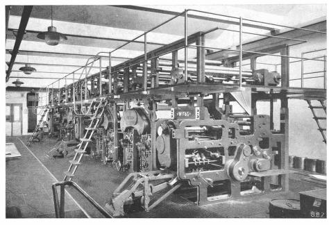
Abb. 17. Die Rotationsdruckmaschine, Oberwerk im Erdgeschoss
