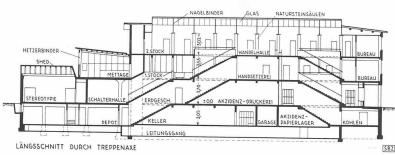
Abb. 12. Längsschnitt durch den Hochbau (Mitteltreppe) 1:500 Weitere Schnitte siehe Seite 227
