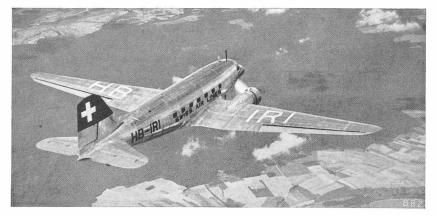
Abb. 1. Verkehrsflugzeug Douglas DC-3 der Swissair, versteifte Schalenkonstruktion
