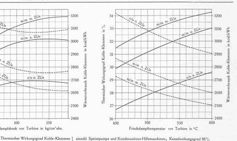
Abb. 7. Einfluss des Frischdampfdruckes auf therm. Wirkungsgrad und Wärmeverbrauch einer 50 000 kW-
