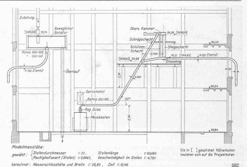
Abb. 9. Schnitt 1:150 der Versuchsanstalt mit dem eingebauten Wasserschloss-Modell
