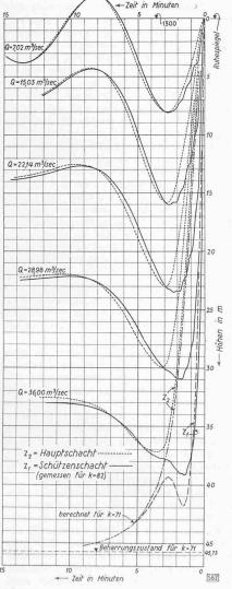
Abb. 11. Oeffnungs-Versuche für k=82 und Q=7 bis 36 m³/s
