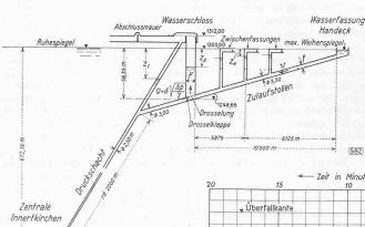
Abb. 8. Schema der Wasserzuleitung
