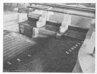
Abb. 1. Symmetr. HW-Abfluss (985 m3/s)
