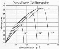
Abb. 1 und 2 (oben). Gemessene Wirkungsgrade der neuen Escher Wyss-Verstellpropeller für Flugzeuge
