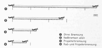
Abb. 5. Gemessene Ausroll-Strecke bei der Landung eines modernen Jagdflugzeuges, ausgerüstet mit Escher Wyss-Verstellpropeller
