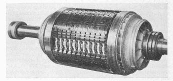
Abb. 8. Rotor des Oerlikon-Synchronmotors in Oberems
