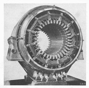
Abb. 7. Stator des Oerlikon-Synchronmotors
