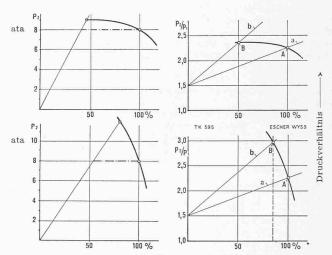
Abb. 3. Bei Saugdrosselung gibt flache Charakteristik beste Anpassung an konst. Druckbedarf bei verschied. Belastungen
