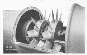
Abb. 5. Axialgebläse werden bis zu vier Stufen mit im Betrieb selbsttätig verstellbaren Laufschaufeln gebaut
