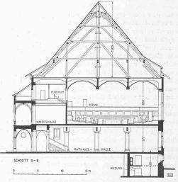
Abb. 10. Querschnitt des umgebauten Rathauses 1:500
