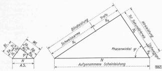
Abb. 7. Leistungsdreieck für  $2 \times 1$  mm Eisenblech
