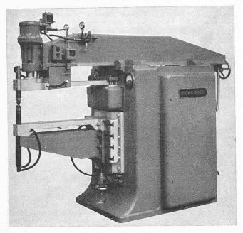
Abb. 6. Druckluftbetätigte Erown-Boveri-Punktschweissmaschine, speziell zum Verschweissen von Aluminium, mit einstellbarer Fensteröffnung. Stufenlose Regulierung des Schweisstromes, der Schweisszeit und des Elektrodendruckes bürgt für wirtschaftliche und zuverlässige Schweissung
