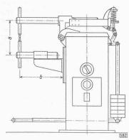
Abb. 1. BBC-Punktschweissmaschine mit verstellbaren Schweissarmen a Abstand der Schweissarme
