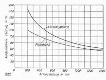
Abb. 4. Aufgenommene Leistung in Funktion der Armausladung bei konstantem Armabstand und konstanter Leerlauf-Sekundärspannung (notwendige Anschlussleistung für Al s. Abb. 5) Kurve 1 für Eisenblech,
